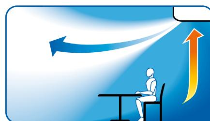
Kod Flexi uređaja, pomoću lamela za usmeravanje vazduha, vazdušna struja se može usmeriti tako da vazduh struji iznad ljudi.
