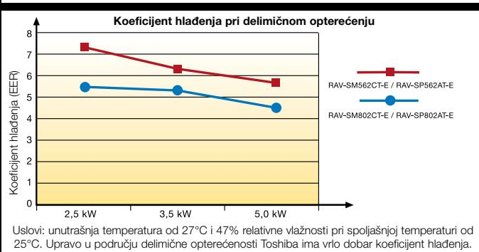
Uslovi: unutrašnja temperatura od 27°C i 47% relativne vlažnosti pri spolašnjoj temperaturi od 25°C. Upravo u području delimične opterećenosti Toshiba ima vrlo dobar koeficijent hlađenja.
