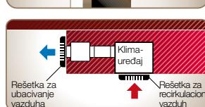
Ak nemáme k dispozícii zavesený podhlás, potom sa dá na jednej strane miestnosti vytvoriť spusťtený podhlás a zabezpečiť takmer neviditeľnú klimatizáciu.
