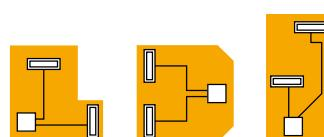
Kod kanalskih uređaja moguće su vrlo različite varijante ugradnje. Ugradnjom nekoliko vazdušnih kanala i elemenata za ubacivanje vazduha moguće je postići optimalnu raspodelu vazduha u prostoriji.
