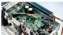
U spoljašnjoj jedinici se nalazi specijalno kućište koje štiti elektronske komponente i osigurava rad čak pri temperaturi od 85°C ali takođe i pruža zaštitu od širenja požara.
